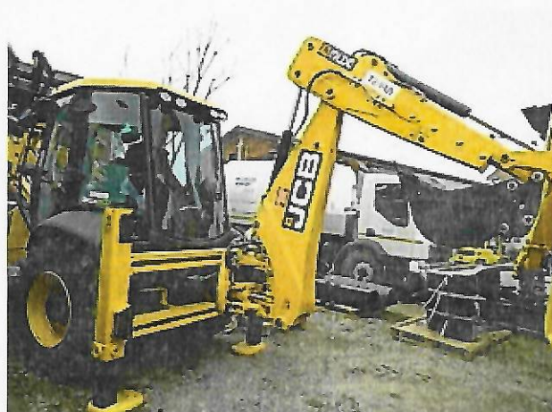
Slike 1a. i 1b. Bager utovarivač-kombinovana mašina sa utovarivačkom i rovokopačkom kašikom
